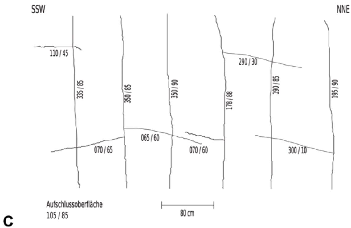
Abb. 8: Klüfte im Aufschluss 3. A, B: Ausschnitt des geklüfteten Diamikts mit vertikalen und horizontalen Klüften. Rechts unten im Bild Trockenrisse. C: Schematische Darstellung der Klüfte und der Kluftorientierungen.
