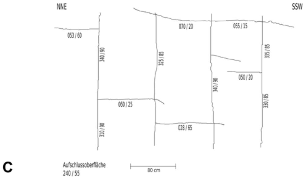
Abb. 6: Klüfte im Aufschluss 2. A, B: Vertikale Kluft und horizontale Klüfte im regelmäßigen Abstand von 10-30 cm. Oben links sind Trockenrisse (blau) erkennbar. Diese unterscheiden sich deutlich von den vertikalen und horizontalen Klüften, nicht zuletzt durch ihre Unregelmäßigkeiten. C: schematische Darstellung der Klüfte und der Kluftorientierungen.
