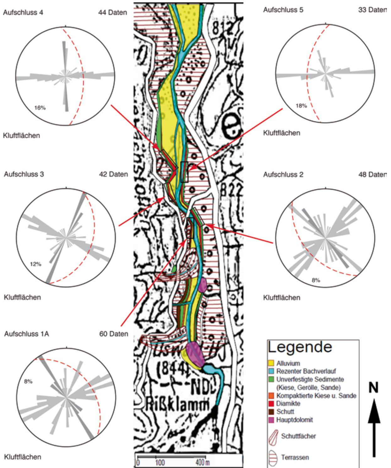
Abb. 3: Detailkarte des untersuchten Gebiets auf Grundlage der Bayerischen Topographischen Karte 1:25.000. Am Rand die Orientierung der gemessenen Klüfte in Rosendiagrammen. Die Orientierung der Klüfte ändert sich mit der Orientierung der Aufschlußoberfläche (roter gestrichelter Großkreis). Hellgraue Balken: subvertikale Klüfte, dunkelgraue Balken: subhorizontale Klüfte.
