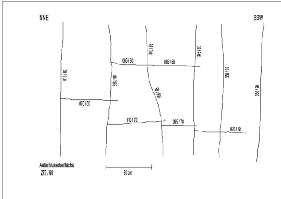
Abb. 10: Klüfte im Aufschluss 5. Schematische Darstellung der Klüfte und der Kluftorientierungen.
