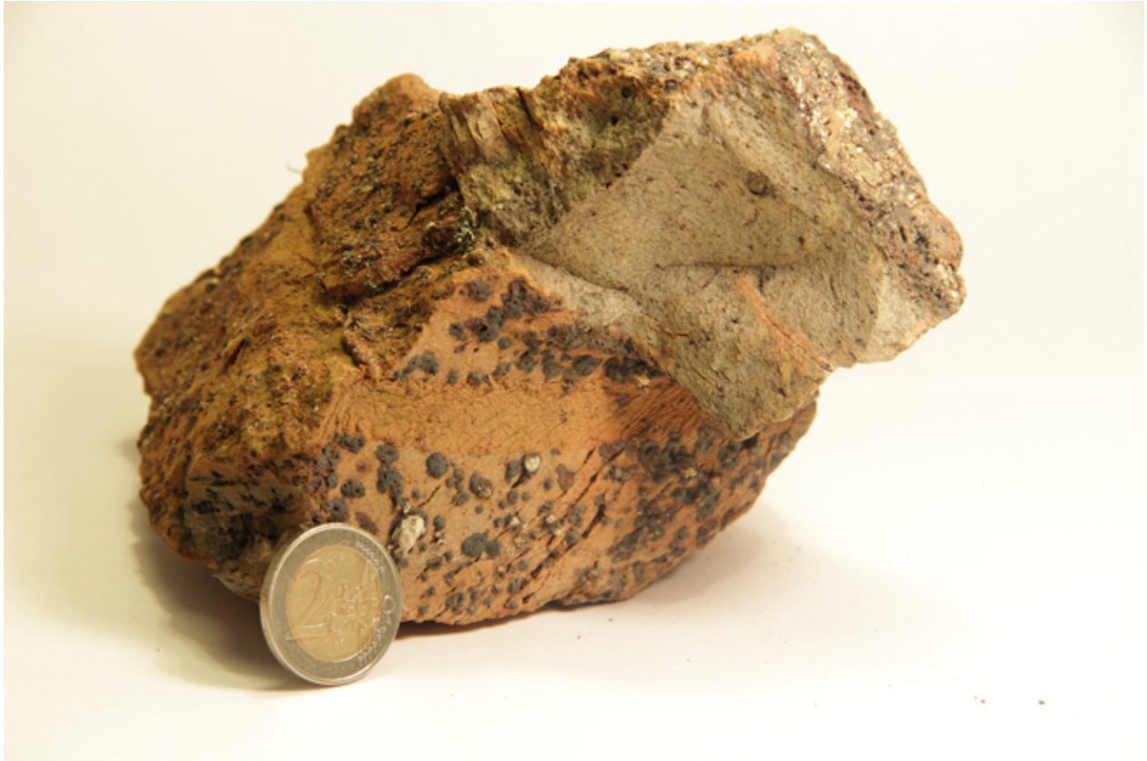
Abb. 6: Das Foto zeigt eine der untersuchten Proben. Auffallend ist, dass einzelne Gesteinsstücke bereits miteinander verschmolzen sind. Die rötliche Oberflächenfarbe ist ebenfalls charakteristisch für die einzelnen Proben. Erst im Anschlag oder im Anschnitt ist die ursprüngliche gräuliche Farbe des Gesteins (= Brixner Quarzphyllit) erkennbar. An der Oberfläche haften Schlackentröpfchen, bei denen es sich um ehemalige Granate handelt, die jetzt aber nur mehr als Pseudomorphosen vorliegen.
