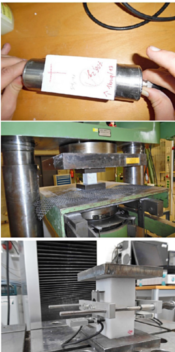
Abb.5: Messeinrichtungen zur Bestimmung des statischen und dynamischen E-Moduls sowie der Bruchlast und Druckfestigkeit. Oben: Ultraschallmessung an einem Prisma (10*5*5 cm) zur Bestimmung des dynamischen E-Moduls. Mitte: Probenwürfel (7*7*7 cm) unter der Druckprüfmaschine AMSLER (5000 kN) zur Bestimmung der Bruchlast und Druckfestigkeit. Unten: Prismatischer Probenkörper (10*5*5 cm) in der Prüfmaschine zur Bestimmung des statischen E-Moduls.
