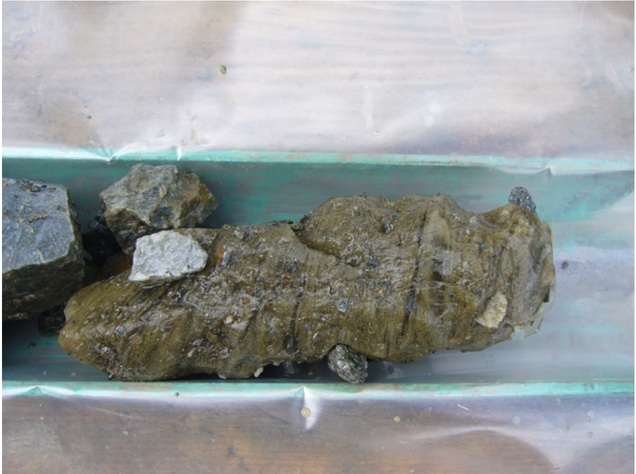
Abb. 14: Bohrkern bestehend aus gebändertem Eis und feinkörnigem Sediment mit einigen Steinen aus der Bohrung Lazaun I.
