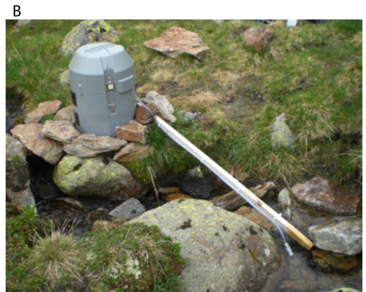
Abb.5. (A) Krummgampenblockglacier, (B) Automatischer Probesammler am Blockglacierscherbach KG-3. (Fotos: Hansjörg Thies).
