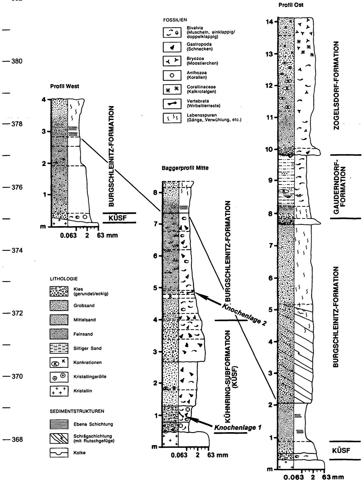
Abb. 4: Säulenprofile des westlichen, mittleren und östlichen Teiles der Sandgrube Stranzl bei Maigen und der Position der Knochenlagen 1 und 2.
