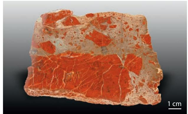
**Abb. 9:** Unteres Kalkflöz. Hornsteinbreccie mit mergeligem Bindemittel. Freital, Fuß des Windberges (Slg. W. Reichel; Foto: B. Bastian).
