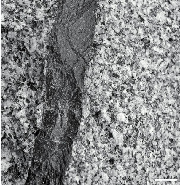
**Abb. 12:** Granodiorit, Typ Herrnhut, mit basaltoidem Gang vom ehemaligen Tagebau Valtengrund. Inv.-Nr. MMG: PET SA 107570 (Maßstab = 1 cm; Foto: J.-M. Lange).
