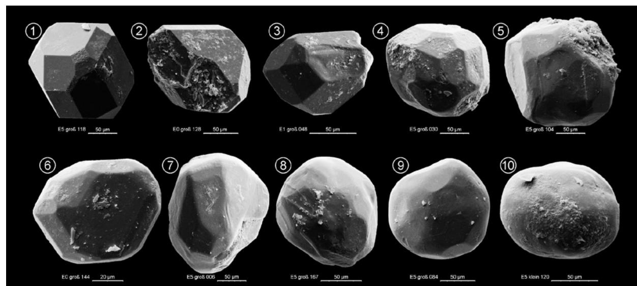
**Fig. 1.** One zircon grain exemplifying each of the ten classes of roundness (1 to 10, scale bar: 50 µm).**Abb. 1.** Ein beispielhaftes Zirkonkorn aus jeder der zehn Klassen der Rundheit (1 bis 10, Maßstabsbalken: 50 µm).
