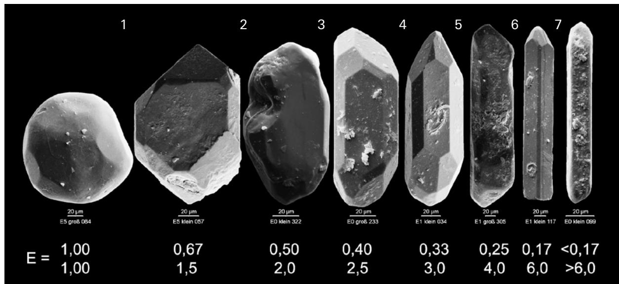
**Fig. 2.** The different classes of elongation exemplarily shown by characteristical grains representing the limiting values of each class (scale bar: 20  $\mu\text{m}$ ).**Abb. 2.** Darstellung von charakteristischen Körnern der verschiedenen Elongationsklassen, welche jeweils die Grenzwerte der Klassen aufweisen (Maßstabsbalken: 20  $\mu\text{m}$ ).
