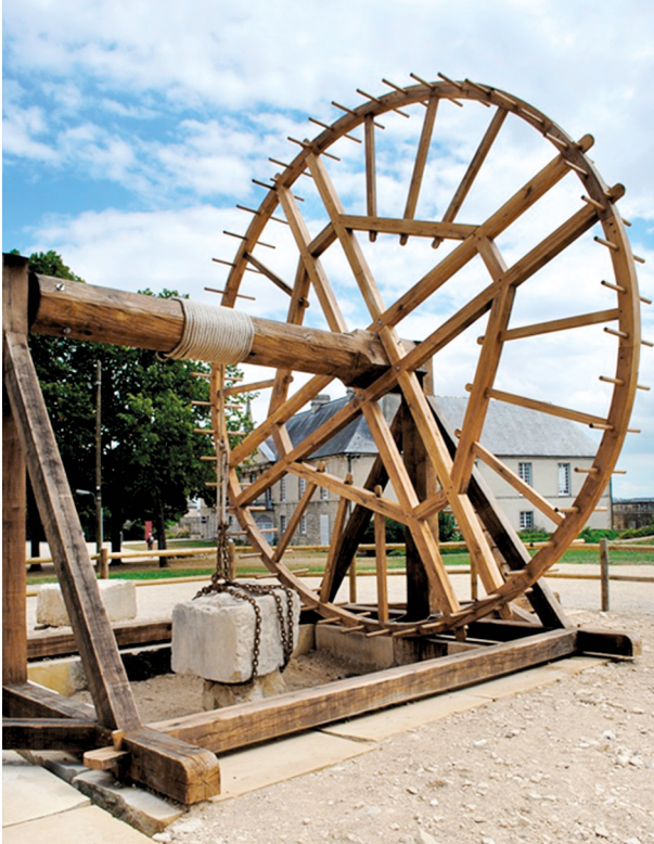
Abb. 17. Historische Winde zur Förderung von unter Tage gewonnenen Kalksteinblöcken in Caen (Frankreich), Nachbau (2010). Ähnlich könnten die Förderanlagen für Sandstein in Zwickau ausgesehen haben.
