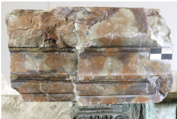
Abb. 16. Roter Knollenkalk, wahrscheinlich von Grünau bei Wildenfels, in einem Fragment vom Rand des Taufbeckens (angefeuchtet; Foto: D. Krause).
