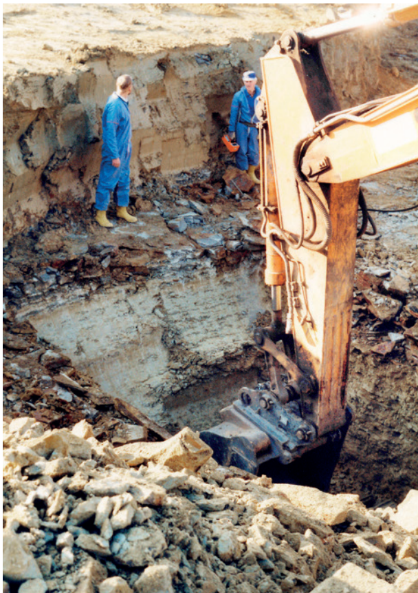
Abb. 35. Schurf für die Untersuchung der Fällungsprodukte im Labiatus-Pläner (Profil: Hangendes ca. 2 m Gehängelehm bis Oberkante des Labiatus-Pläners, ca. 0,3 m Reaktionsbereich des sauren Sickerwassers im Labiatus-Pläner mit Eisenoxiden/-hydroxiden, Liegendes Mergelstein des Labiatus-Pläners, grau).
