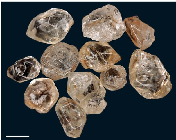
**Abb. 16.** Ursprünglich rötlich braune Zirkone nach thermischer Behandlung (Auflicht, Polarisationsfilter; Maßstab = 2 mm).
