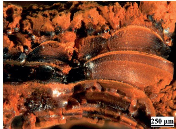
Abb. 2. Muschelige Bruchflächen in der Schwertmannit-Kruste der Probe S-1 (Freiberg).
