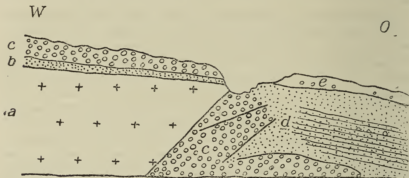
Fig. 1. Überschiebung bei Relanges nordwestl. Darney. a Granit; b geröllfreier, grobkörniger Sandstein; c Hauptkonglomerat; Gerölle nur in der eingekleiteten Zone zerquetscht; d feingeschichteter Oberer Buntsandstein mit Karneolbrocken; e Verwitterungsdecke.
