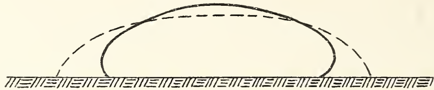
Fig. 2. Querschnitt durch die Stirn eines Murschubes in Bewegung (ausgezogene Linie) und nach der Erstarrung (gestrichelte Linie).
