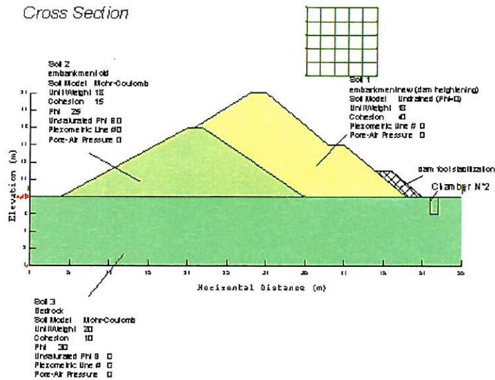
**Abb. 1: schematische Darstellung der Dammausführung**
