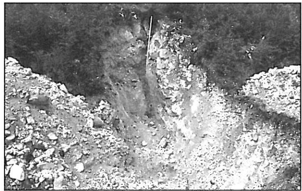
Abb. 1: Durch Bohren, Sprengen und anschließendes Ausbaggern hergestellte Schürfe zur Beurteilung einer Dolomitlegerstätte; St. Gilgen
