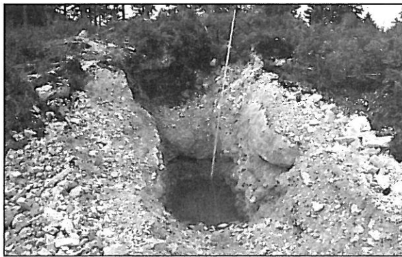
Abb. 1: Durch Bohren, Sprengen und anschließendes Ausbaggern hergestellte Schürfe zur Beurteilung einer Dolomitlegerstätte; St. Gilgen
