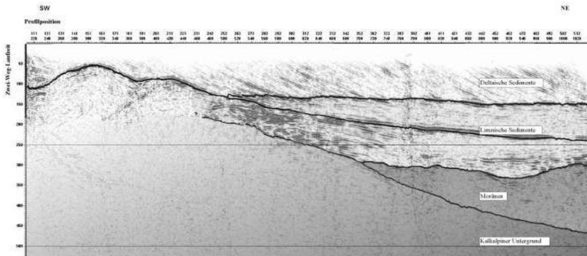
Abb. 2: Seismische Sektion (Tallängsprofil) in Ebensee
