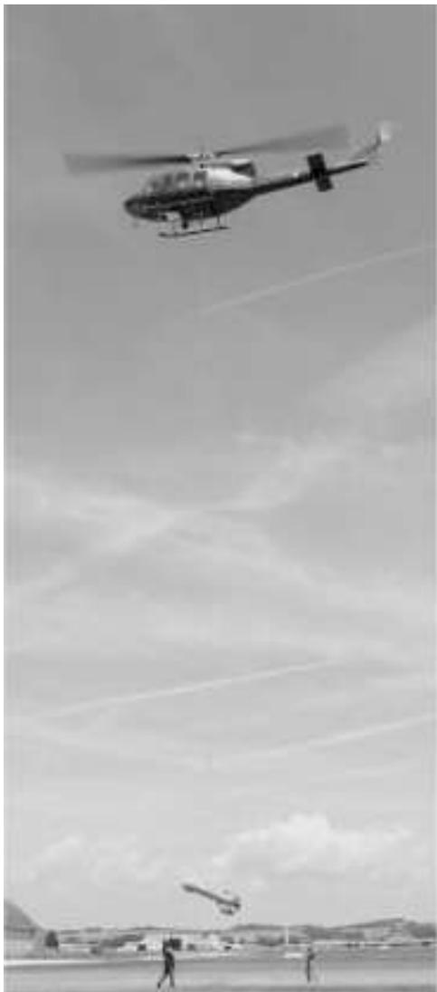
Abb. 3: Hubschrauber und Messsonde der österreichischen Aerogeophysik
