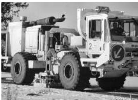
Abb. 6: Bei der hochauflösenden 2-D Seismik im Ischltal eingesetzter Vibrator
