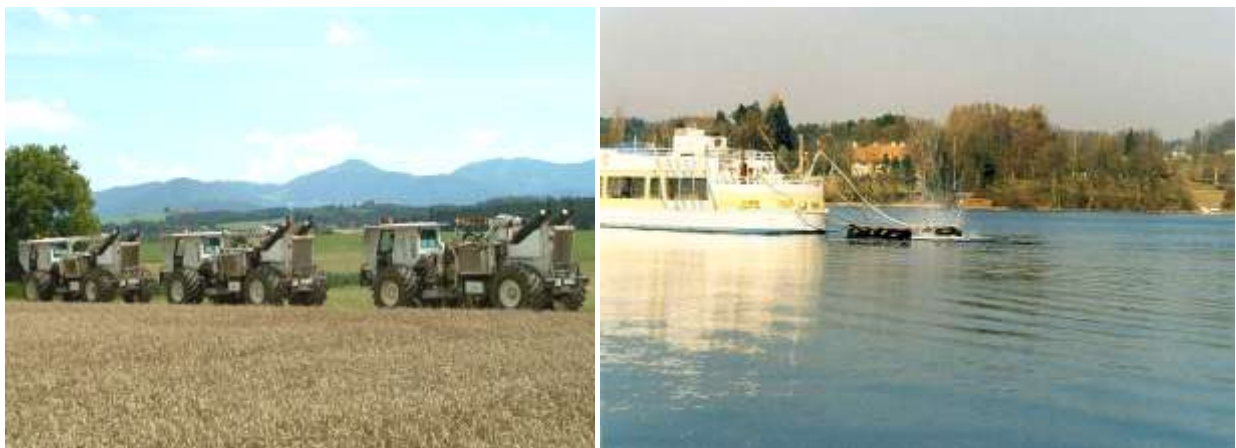
Abb. 8, 9: Seismik Aquisition im Pettenbach-Gebiet; See-Seismik im Nordbereich des Atterseees
