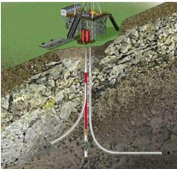
**Abb. 5: Schematische Darstellung von Richtbohrungen**
