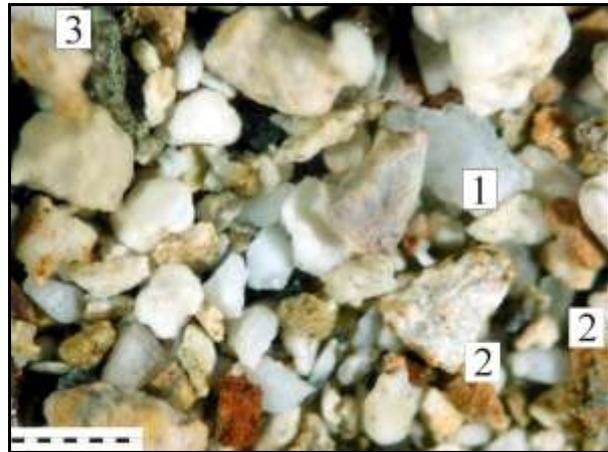
Abb.13: Sov-1 (entkalkt), Balken 0,5 mm, Quarz/Cristobalit (1), gefrittetes Gestein (2 rötlich bräunlich), Schlacke (3)
