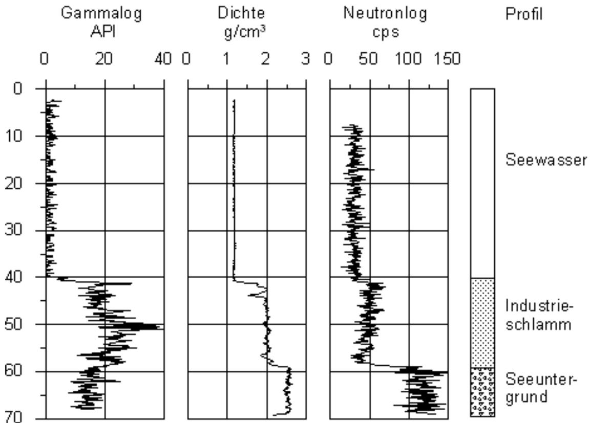
Abb. 7: Ergebnisse geophysikalischer Bohrlochmessungen in der Bohrung Sov-1. Es sind dargestellt (von links nach rechts): die Kurve der natürlichen Gammastrahlung in API-units, die Gamma-Gamma-Dichtekurve in g/cm<sup>3</sup>, die Kurve der Neutronintensität in cps (counts per second).
