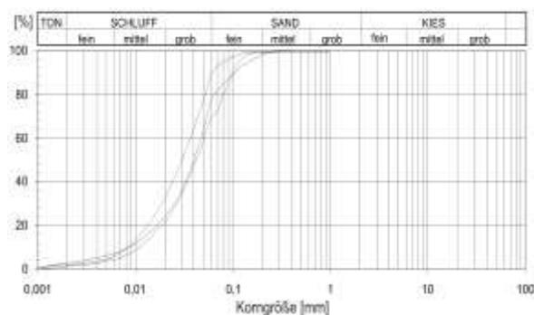
Abb. 9: Bohrung Sov-2, Korngrößenverteilung der Proben 2a-d
