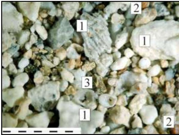
Abb.12: Sov-1 (entkalkt), Balken 2 mm, Quarz/Cristobalit (1), gefrittetes Gestein (2), Schlacke (3)
