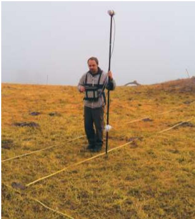
*Abb. 4: Magnetik Feldmessungen – zwei Magnetfeldsensoren montiert auf einer Stange*
