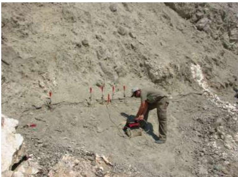
*Abb. 3: Geoelektrische Tiefensondierung*
