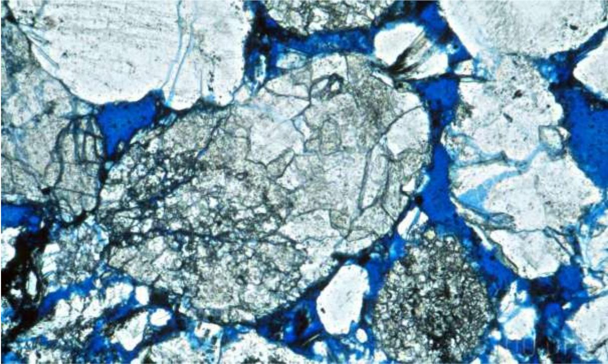
*Abb. 5: Dünnschliff eines Speichergesteins für Erdöl und Erdgas*
