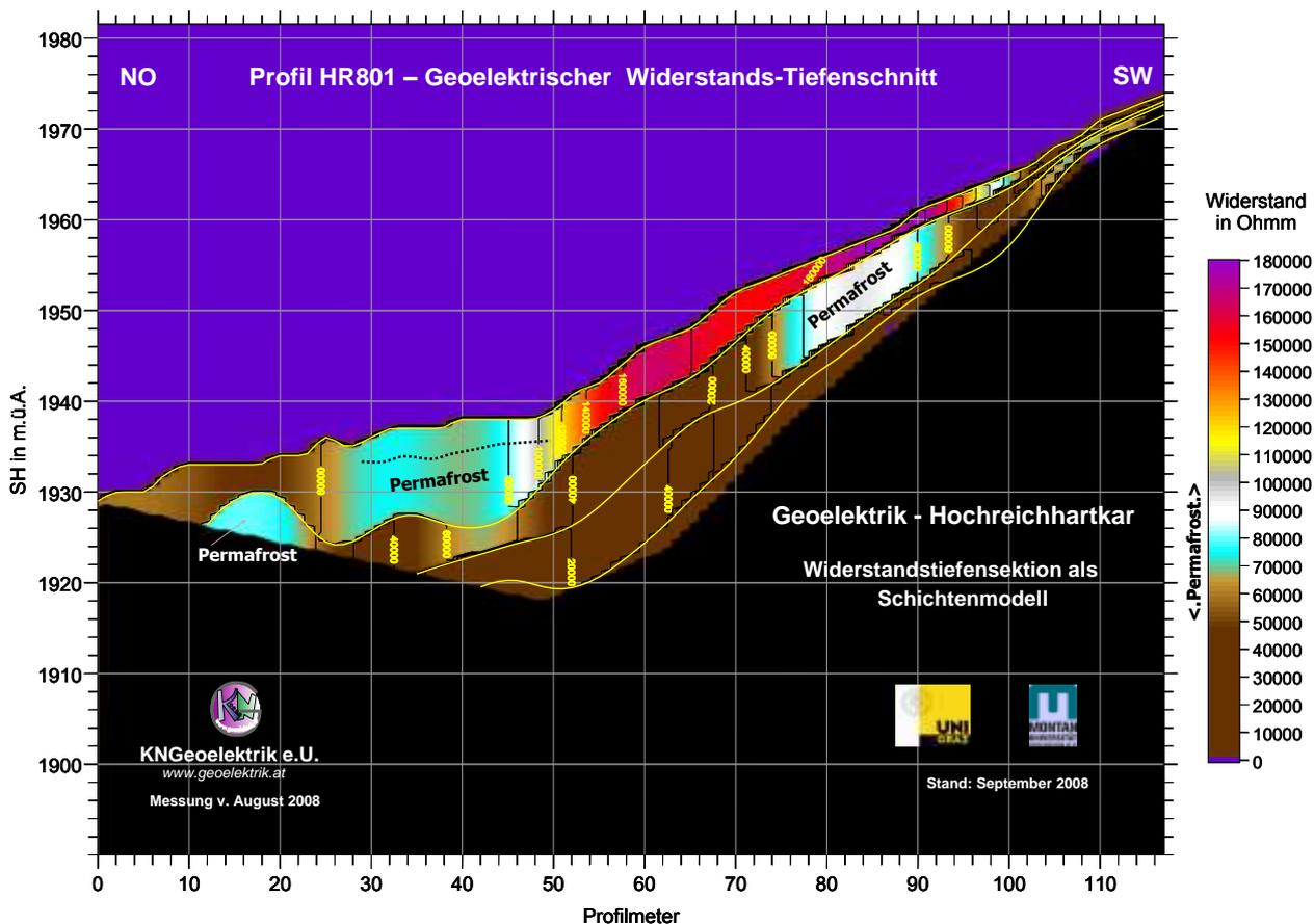
Abb. 5: Ergebnis der Geoelektrikmessungen im Rahmen des ALPCHANGE Projektes: Widerstandstiefensektion des geoelektrischen Profils HR801. (KNGoelektrik)
