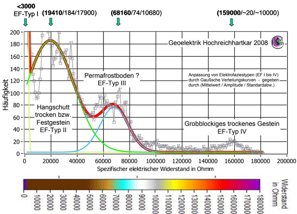
Abb. 4: Histogramm der elektrischen Widerstände am Messprofil und Zuordnung zu Elektrofaziestypen.
