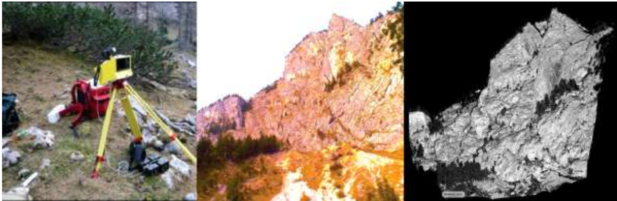
Abb. 4: Terrestrischer Laser Scanner (links), Foto der Himbeersteinwand im Nationalpark Gesäuse (Mitte) und dessen Abbildung als Punktwolke (rechts)
