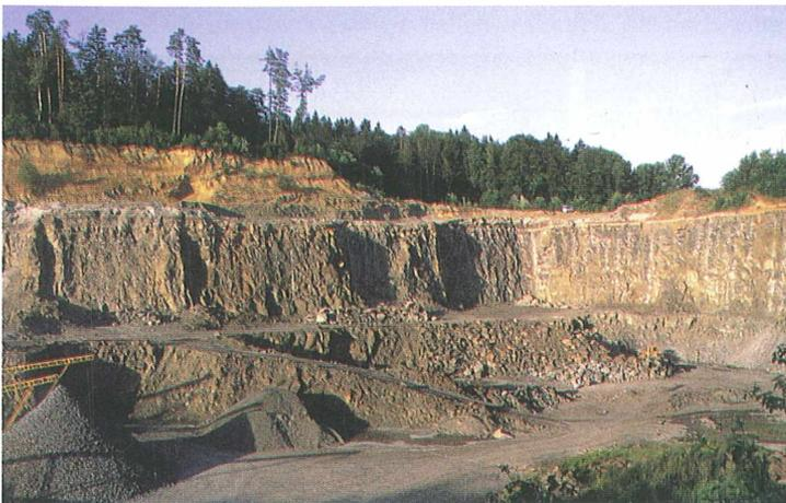
So baut man beispielsweise im **Basaltsteinbruch von Weitendorf** in einer großen Grube Basalt ab, der zu Straßenschotter gebrochen wird. Das dunkle Gestein liegt – und das war der Grund diesen Bruch zu schützen – auf tonigen Ablagerungen des mittleren Miozäns (Badenium), die sehr fossilreich sind und damit auch eine zeitliche Einstufung des Basalts erlauben.
