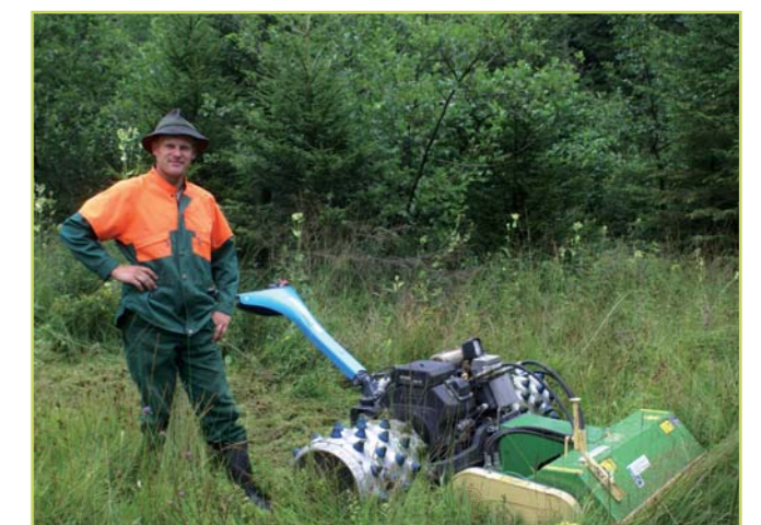
Brielmaier Motormäher mit Stachelwalzen; Landwirt Robert Rehr. C.A.
