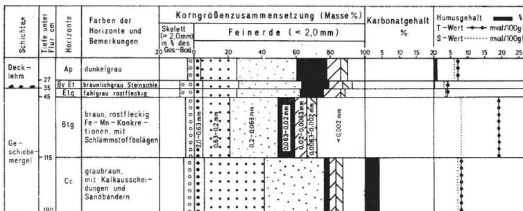
Abb. 19. Schematische Profildarstellung und Analysenergebnisse des Profils 743 A
