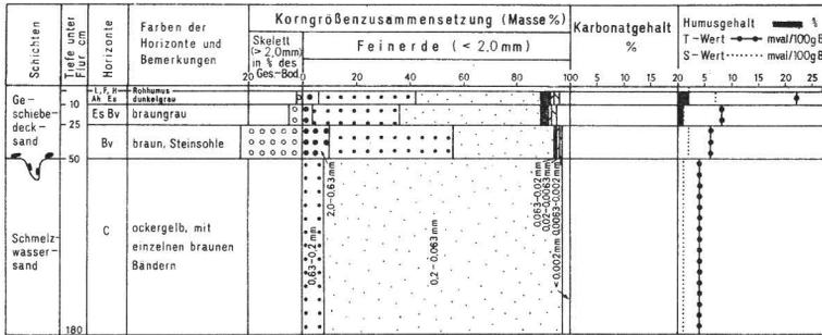
Abb. 9. Schematische Profildarstellung und Analysenergebnisse des Profils 727 A
