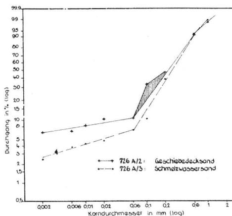
Abb. 13. Beispiele für die Darstellung der KorngröÙenzusammensetzung von Deckschichten und zugehörigen Liegendensedimenten im doppelt-logarithmischen Körnungsnetz (Wahrscheinlichkeitspapier)
