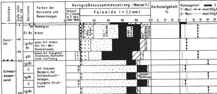
Abb. 7. Schematische Profildarstellung und Analysenergebnisse des Profils 718 A
