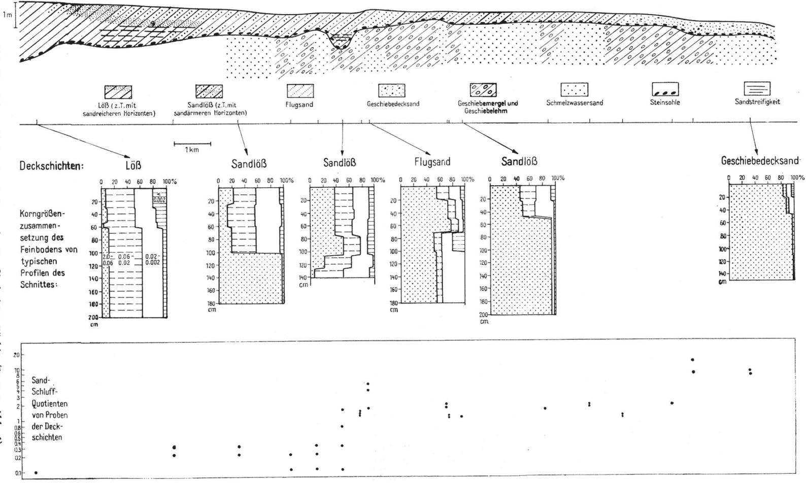
Abb. 11. Schematische Darstellung des Profilschnittes Zörbig (Lage s. Abb. 1) mit Korngrößenzusammensetzung (Blockdiagramme) der typischen Profile und Sand/Schluff-Quotienten der Deckschichten der untersuchten Profile
