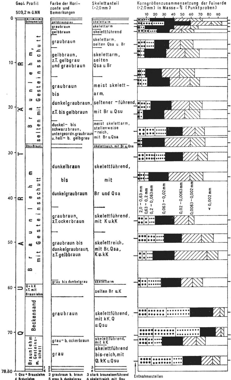
Abb. 11. Geologisches Profil, Korngrößenzusammensetzung und Chemismus der Kernboh-
