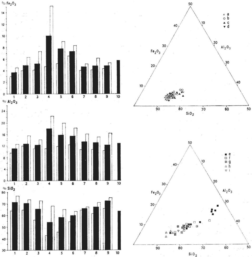
Abb. 7. Die  $\text{Fe}_2\text{O}_3$ -,  $\text{Al}_2\text{O}_3$ - und  $\text{SiO}_2$ -Gesamtgehalte aus der chemischen Vollanalyse (Minima, Mittelwerte, Maxima) der Feinerde (< 2,0 mm) und deren Relativanteile in der Dreiecksdarstellung der verschiedenen quartären Deckschichten.
