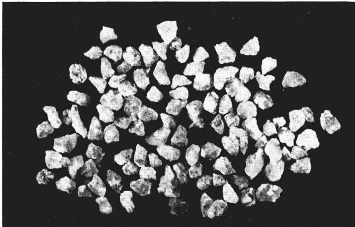
Abb. 4. Mikrophotographie von Quarzkörnern (Fraktion 1,0–1,25 mm) aus dem Verwitterungsmaterial aus Drei Annen-Hohne. Etwa 15fach vergrößert
