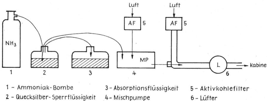
Abb. 1. Apparatur zur Herstellung von  $\text{NH}_3$ -Luft-Gemischen
