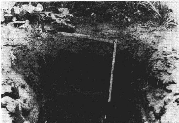
Abb. 3. Schachtung auf dem Gelände der Spülfläche II. Deutlich hebt sich ERS-A mit einer Schichtdicke von ca. 10 cm als hellgraue Schicht vom übrigen Boden ab. Vom Rand her dringen Wurzeln von den umgebenden Pflanzen in die Spülfläche II vor
