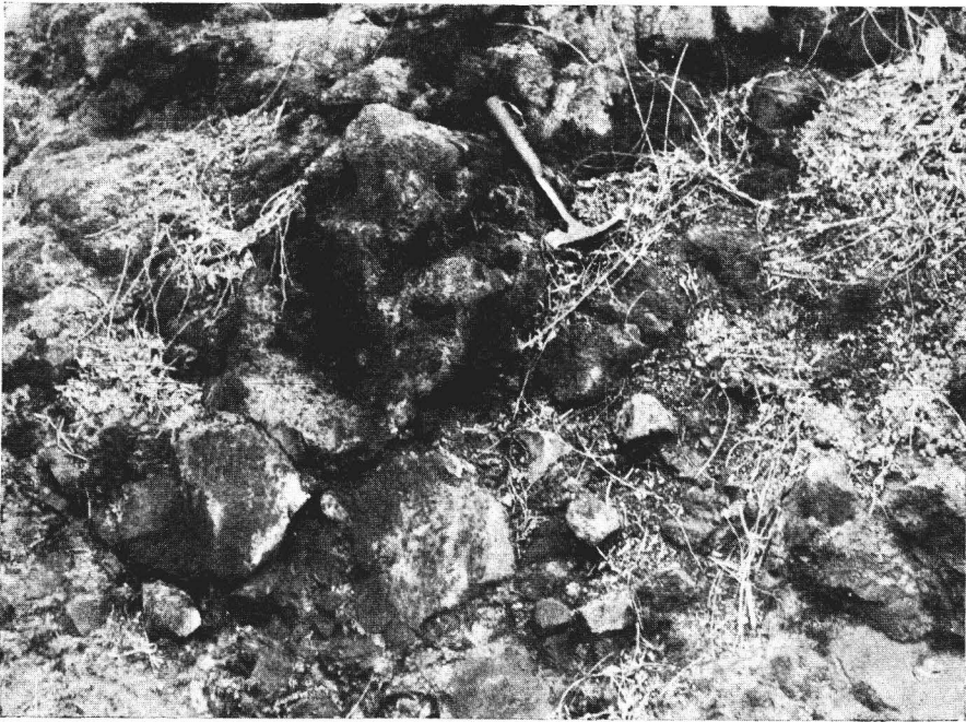
Abb. 4. Verwitterungserscheinung des Porphyrs am Raubvogelkäfig
