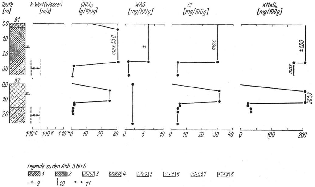
Abb. 3. Kontaminationsprofil der Bohrungen B1 und B2.
