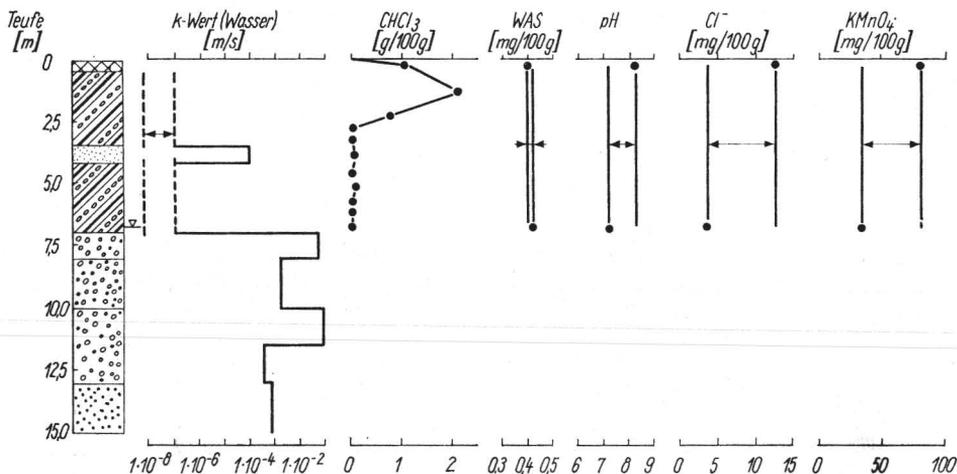
Abb. 5. Kontaminationsprofil der Grundwasserbeobachtungsbohrung GWBR 3 (Legende siehe Abb. 3)
