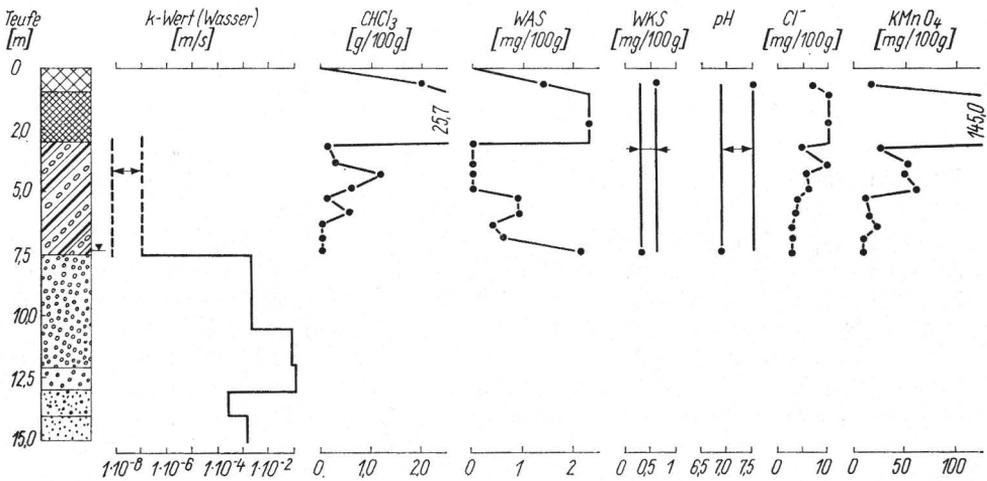
Abb. 4. Kontaminationsprofil der Grundwasserbeobachtungsbohrung GWBR 2
