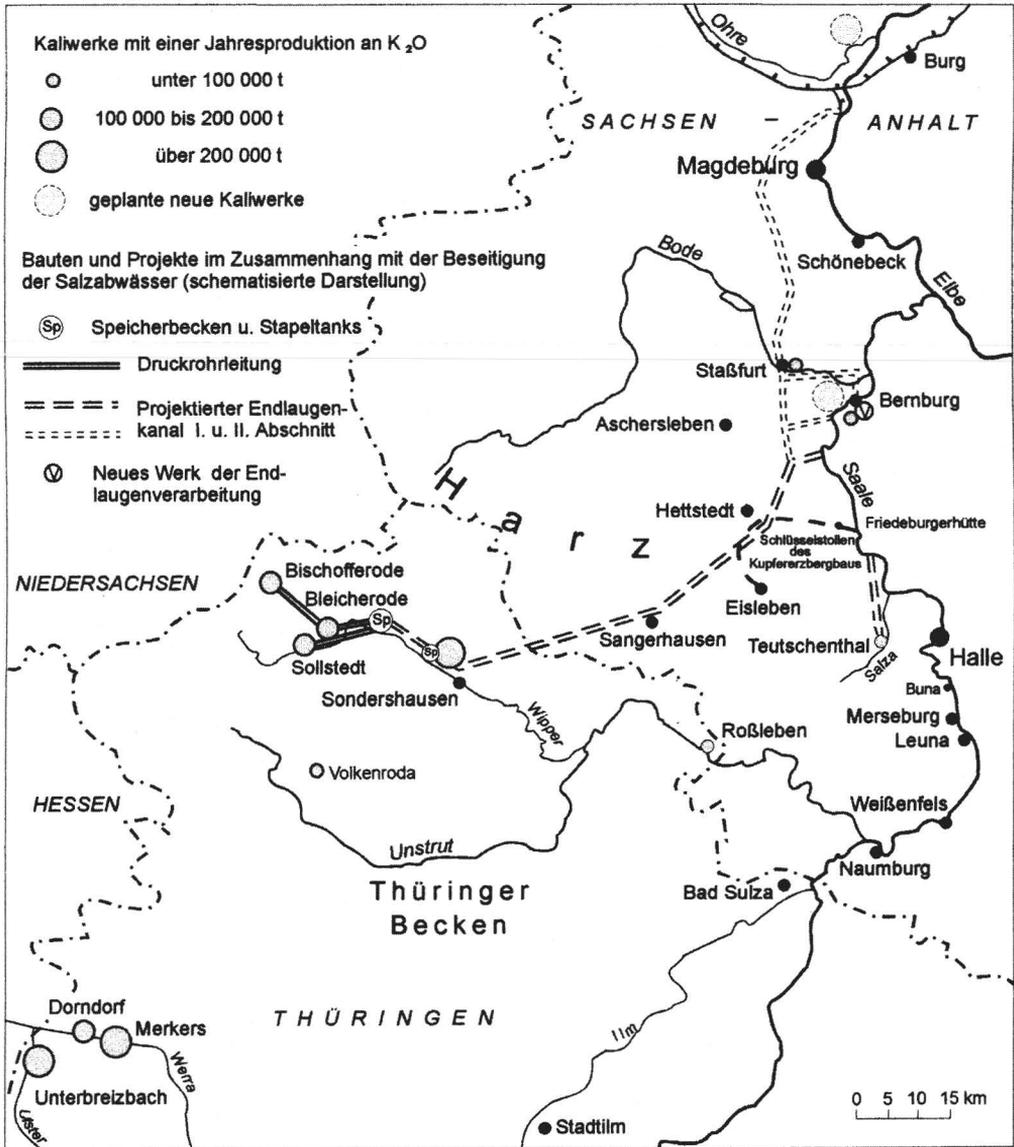
Abb. 1: Verlauf des vorgesehenen Kanales zur Ableitung der Kaliendlaugen aus den Kaliwerken des Südharz-Revieres und des Saale-Bode-Revieres (vereinfacht nach KOHL 1966)
