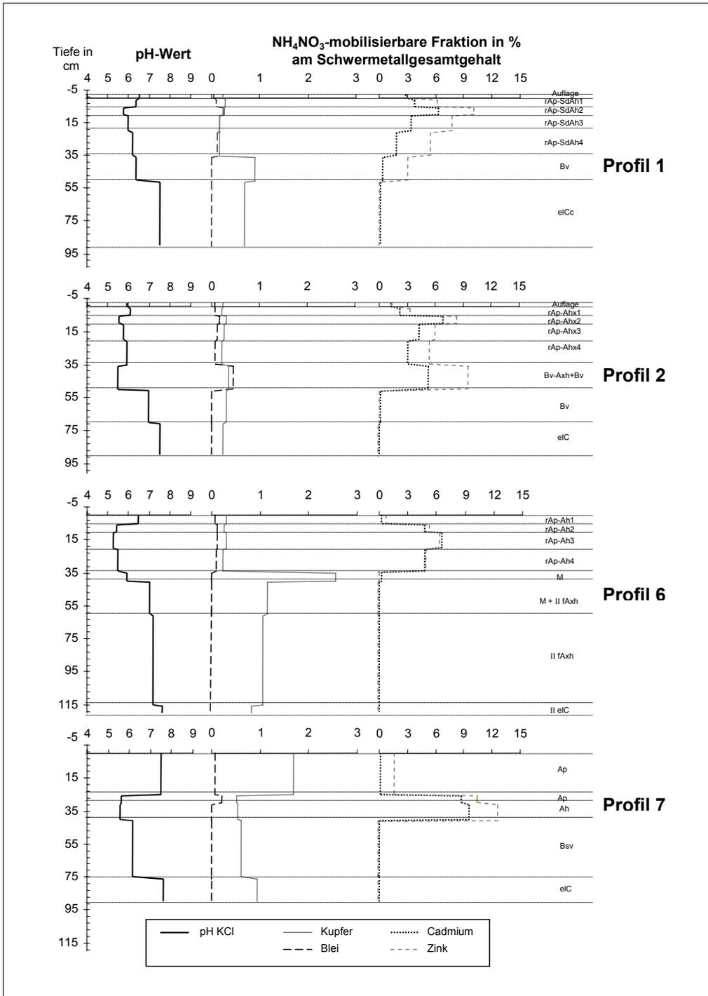
Abb. 3 Graphische Darstellung der NH<sub>4</sub>NO<sub>3</sub>-mobilisierbaren Schwermetаллfraktionen der Profile 1, 2, 6 und 7
