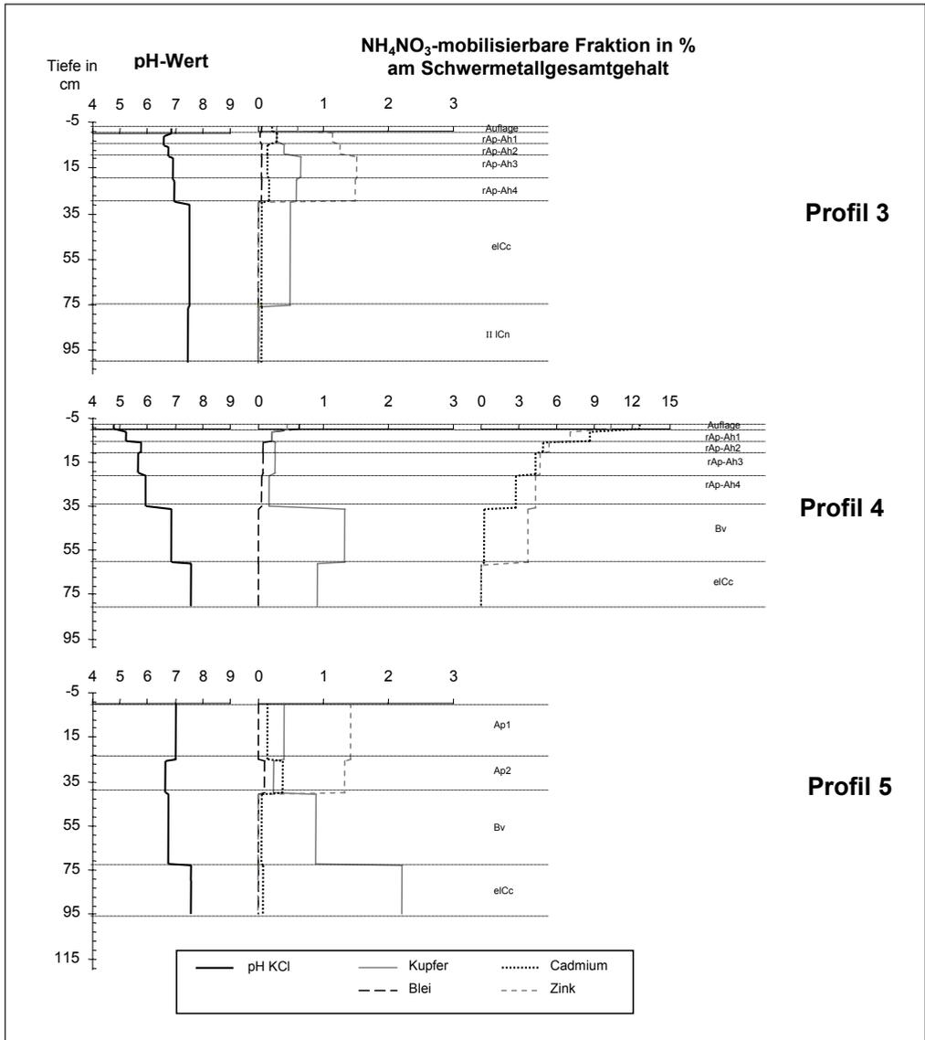
Abb. 4 Graphische Darstellung der NH<sub>4</sub>NO<sub>3</sub>-mobilisierbaren Schwermetallfraktionen der Profile 3, 4 und 5
