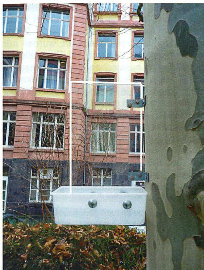
Abb. 1: Stammfensterfalle an einem Platanenstamm vor dem Senckenberg-Institut (Foto: W.H.O. DOROW). Die Tiere prallen gegen eine direkt am Stamm angebrachte Plexiglasscheibe (zur besseren Sichtbarmachung im Bild weiß umrandet) oder geraten laufend oder fliegend in die mit Fangflüssigkeit gefüllte weiße Auffangschale.
