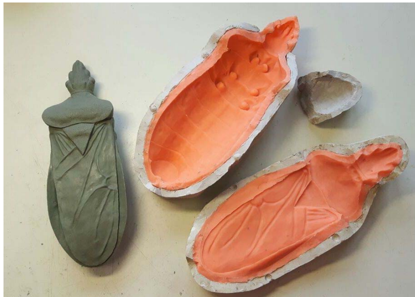
Vom modellierten Körper wurde eine Silikonform erstellt, mit deren Hilfe letztlich der eigentliche Kunstharz-Körper gegossen werden konnte. (Foto: LWL/PETER)
