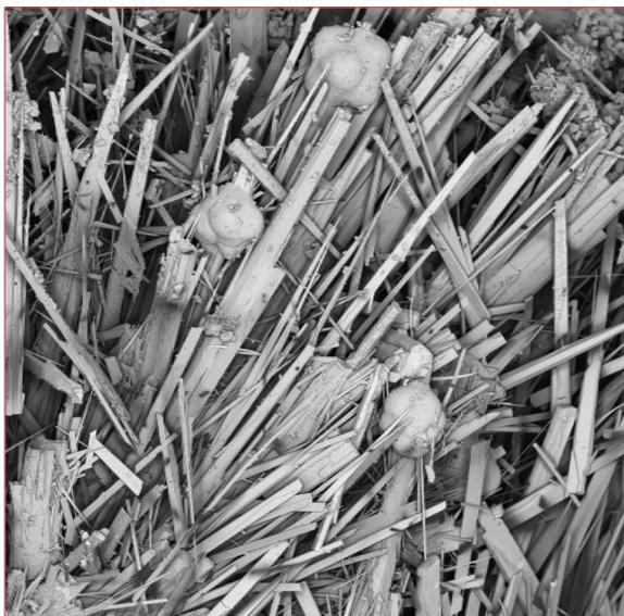
Abb. 16: Probe N21 sekundäre feinkörnige Calcitaggregate auf Aragonitnadeln (Bildbreite: 1,5 mm).
