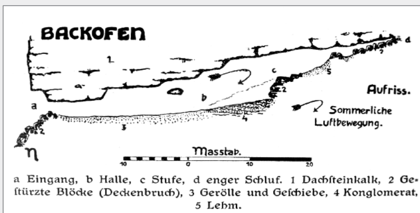
Abb. 8: Die von Bock 1910 benannte Backofenhöhle (1547/11) im Aufriss mit Einzeichnung der „sommerlichen Luftbewegung“ – Backofentypus. Zeichnung Bock 1913.
