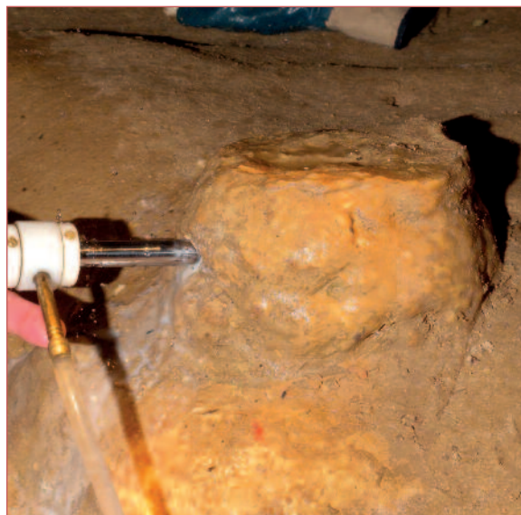
Abb. 6: Basis eines ehemals stattlichen Stalagmiten neben dem sogenannten Sinterkreuz (siehe Abb. 1), von dem zuerst seitlich ein Bohrkern entnommen wurde, später vertikal.
