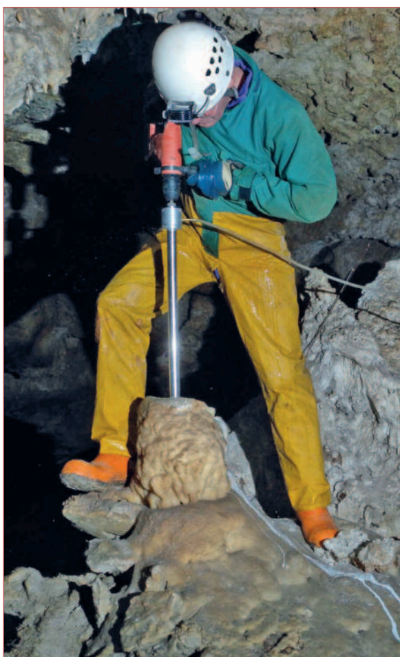
Abb. 3: Kernbohrung (mit Wasserspülung) in den Stalagmiten KRA5.
