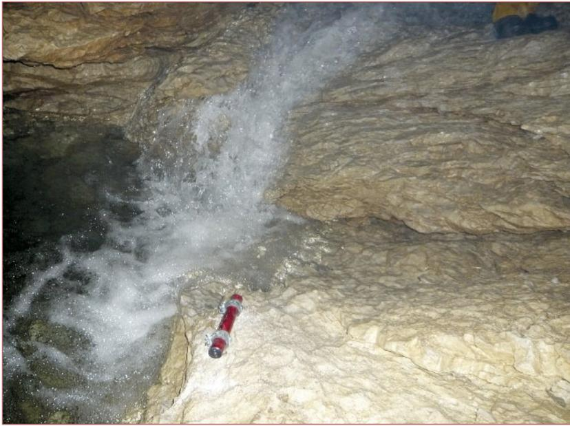
Abb. 16: Drucksonde mit integriertem Datenlogger beim Endsiphon der Bärenhöhle.
