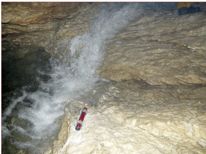
Abb. 16: Drucksonde mit integriertem Datenlogger beim Endsiphon der Bärenhöhle. Fig. 16: Pressure data logger at the final siphon of Bärenhöhle.
