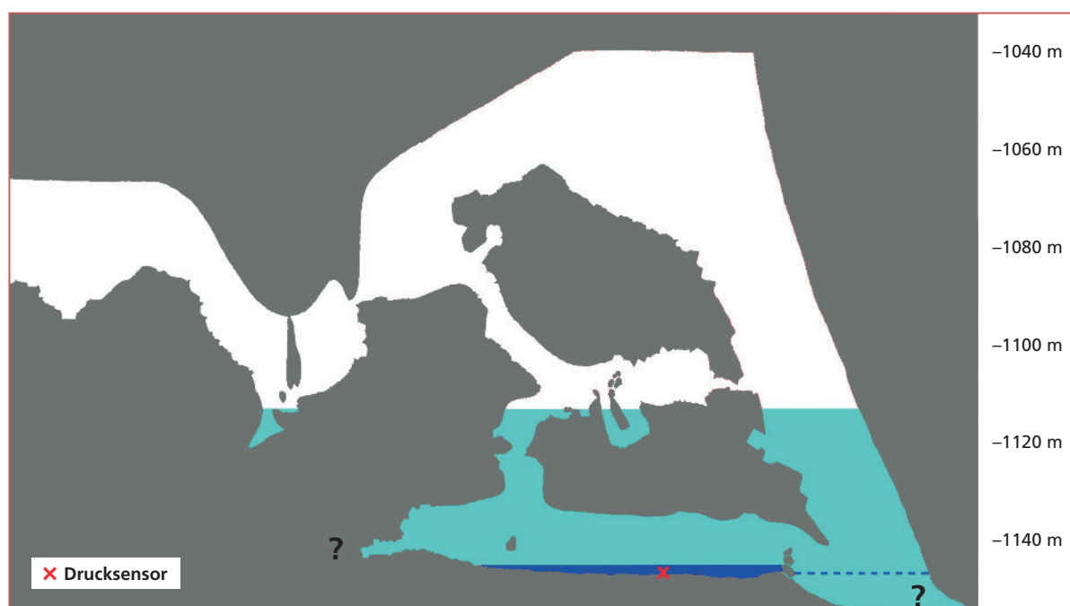
Abb. 10: Aufriss des Endbereiches des Krakencanyons mit gemessenem Maximalwasserstand (hellblau), Normalwasserstand im Endsiphon (dunkelblau gestrichelt), und Rückstau des Krakenbaches an der sperrenden Schotterbank (dunkelblau). Fig. 10: Vertical section of Krakencanyon near the final sump. Light blue indicates the highest observed water-level, the dashed line marks the normal water-level in the sump and dark blue the water-level related to gravel partly blocking Krakenbach.
