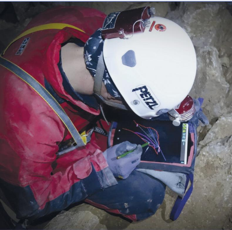
Abb. 4: Höhlenvermessung mit Tablet und TopoDroid.
