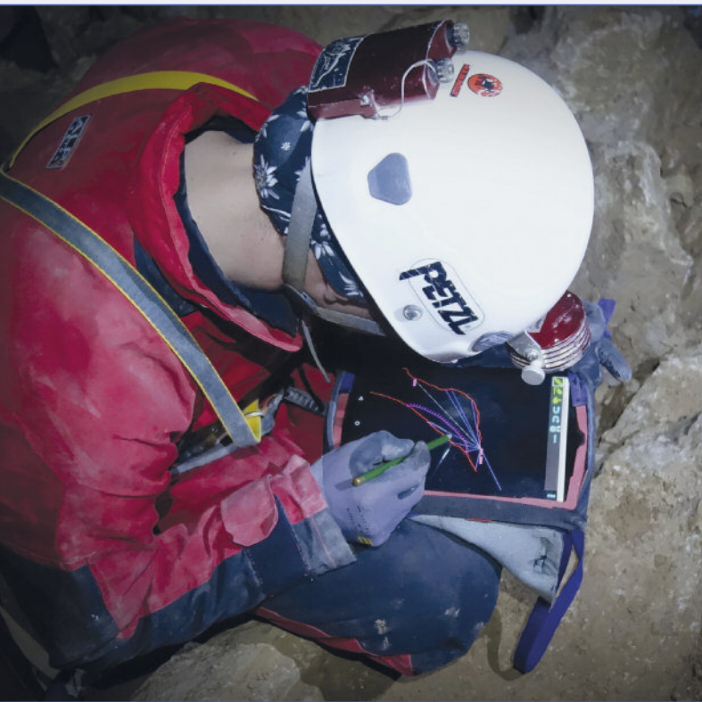
Abb. 4: Höhlenvermessung mit Tablet und TopoDroid. Fig. 4: Cave surveying with tablet and TopoDroid.
