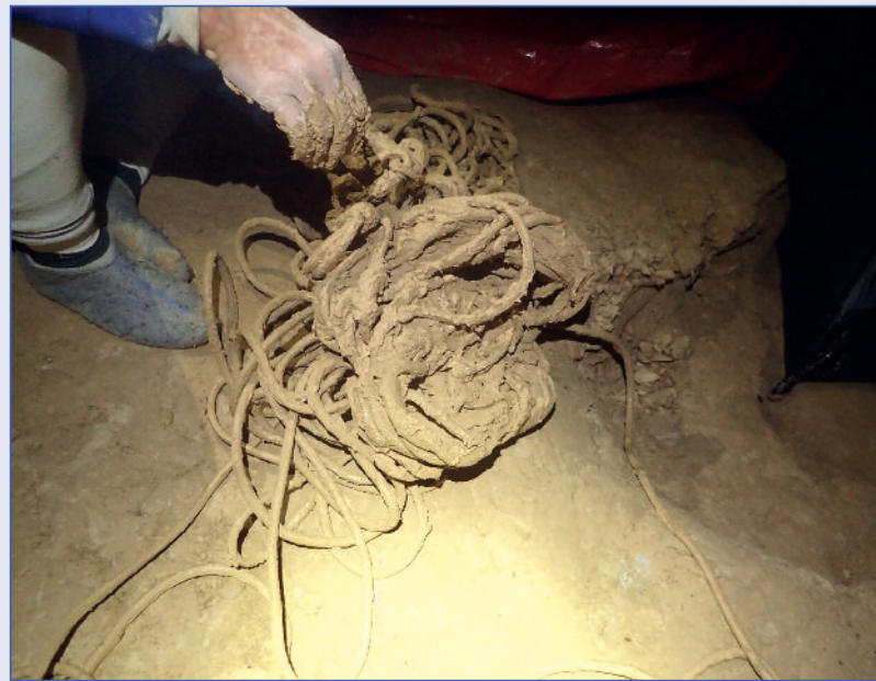
Abb. 4: Verlehmtes Seil, das im Kaugummischlot eingebaut war. Fig. 4: Rope covered by clay, installed in Kaugummischlot.
