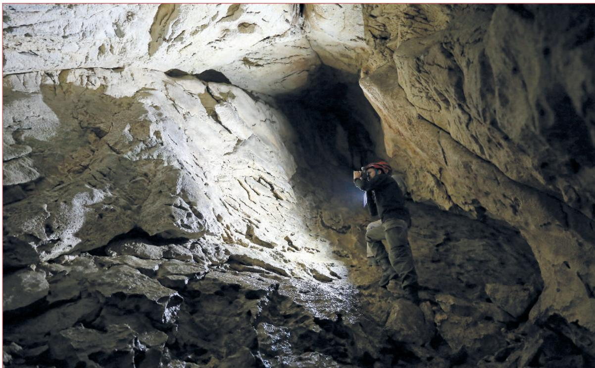
Abb. 3: Eine starke Lichtquelle kann aufgrund der gleichmäßigen Ausleuchtung eines großen Bereichs den Arbeitsablauf erheblich beschleunigen. SfM-Dokumentation in der Bärenfalle mit separat geführtem LED-Strahler mit 2000 Lumen Leistung.
