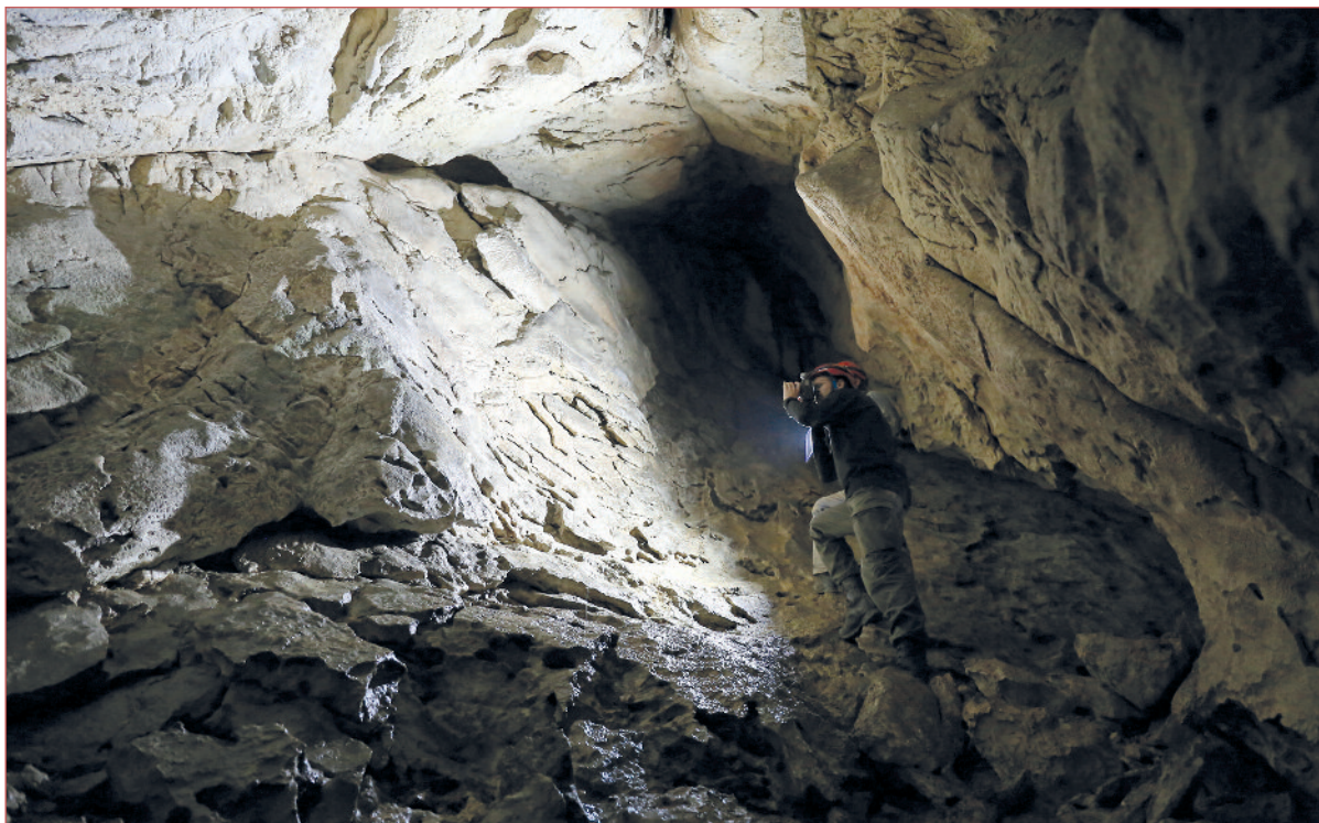
Abb. 3: Eine starke Lichtquelle kann aufgrund der gleichmäßigen Ausleuchtung eines großen Bereichs den Arbeitsablauf erheblich beschleunigen. SfM-Dokumentation in der Bärenfalle mit separat geführtem LED-Strahler mit 2000 Lumen Leistung.
