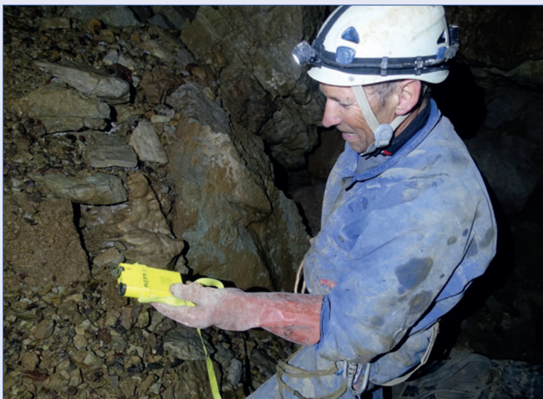
Abb. 15: Lawinenpiepsgeräte ermöglichen eine Ortung durch eine bis zu 30 m mächtige Felsmasse. Fig. 15: Avalanche transceivers enable a location through rock up to a distance of 30 m.
