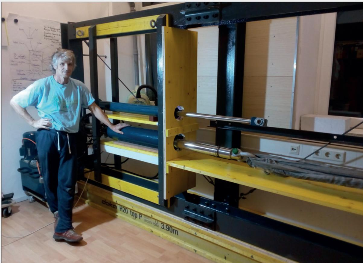
Abb. 2: Zerreißmaschine.
