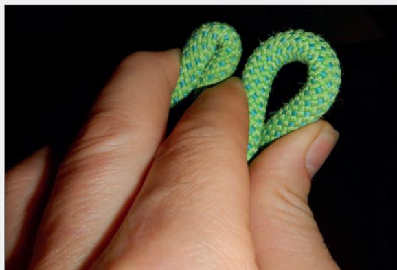
Abb. 7:: Linke Schlaufe ist ein stark benutztes Seil, rechte Schlaufe ist ein neues Seil, das sich nicht zusammendrücken lässt.
