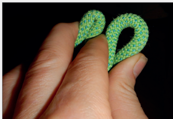
Abb. 7:: Linke Schlaufe ist ein stark benutztes Seil, rechte Schlaufe ist ein neues Seil, das sich nicht zusammendrücken lässt.
